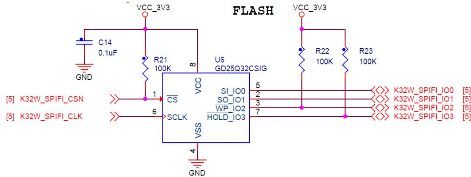
Figure 21. GD25Q32C Quad SPI NOR flash
